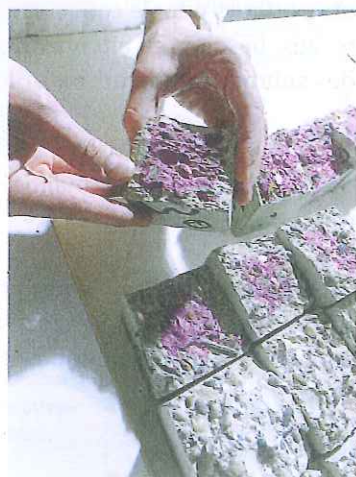
Echantillons de béton en proie au phénomène de « carbonatation » qui conduit à la corrosion des aciers.
